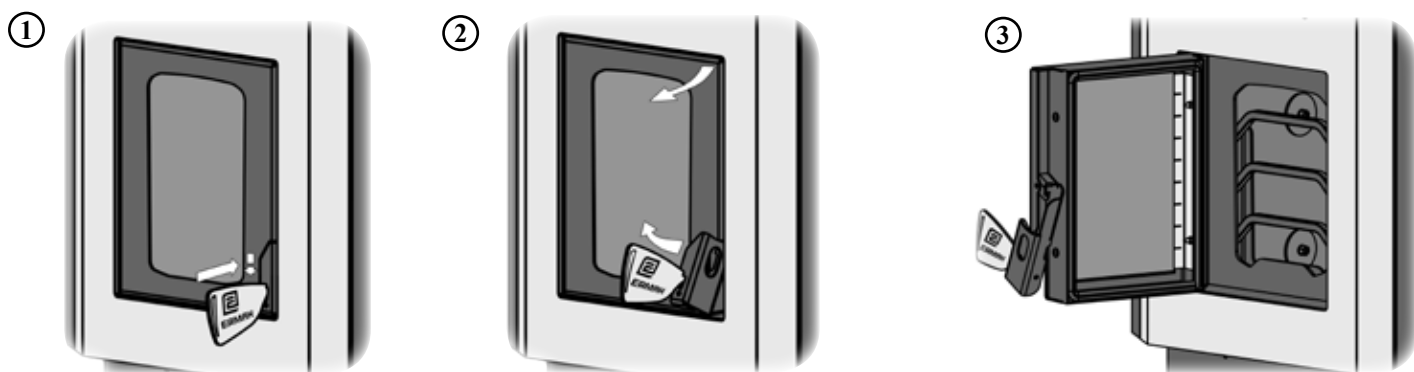
Рисунок - 13. Чистка стекла смотровой двери
